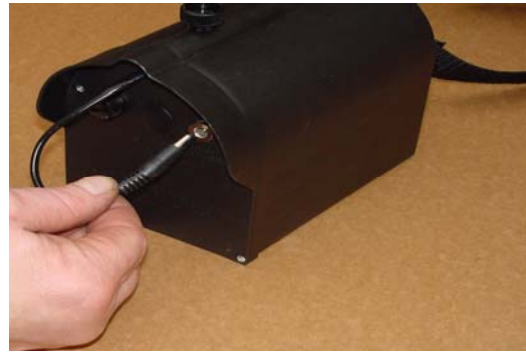
6. Kabel in accubehuizing steken LET OP: VOOR GEBRUIK ACCU OPLADEN!
