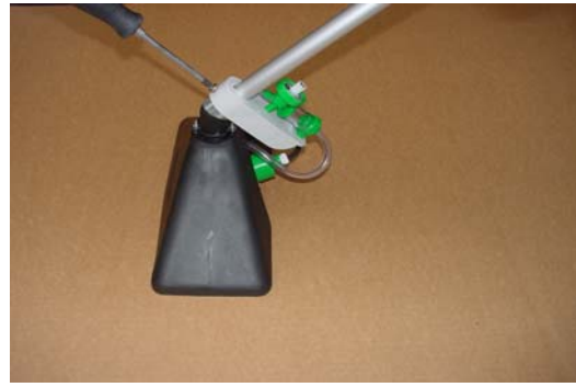
2. Doorstroomcontrole met kap en spuitkapstang verbinden
